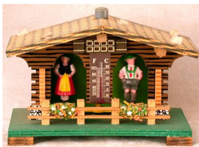
L'igrometro a capello era spesso utilizzato per costruire casette segnatempo
