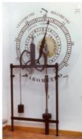
Barometro a bilancia di Cecchi ciò che viene rilevato non è il livello del mercurio, ma il suo "peso" http://catalogo.museogalileo.it/oggetto/BarometroBilanciaCecchi.html
